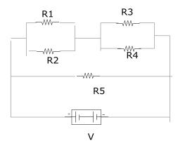
R1=2  $\Omega$ , R2=8 $\Omega$  , R3=3  $\Omega$ , R4= 6  $\Omega$ , R5=7.2  $\Omega$ . V= 6V
